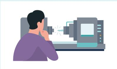
Weil er abgelenkt war, spannte der **Mitarbeiter Rainer T.** einen Rohling nicht korrekt in die Maschine ein. Dadurch kam es zu Unwuchten an der Spindel. Die Spindel wurde erheblich beschädigt und musste ausgetauscht werden.
