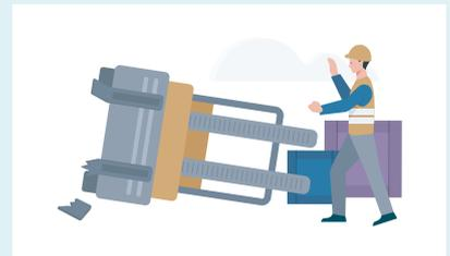
Beim Umsetzen von Paletten missachtete der **Staplerfahrer Paul C.** das maximale Hubgewicht. Dadurch kippte der Stapler um und wurde an der Gabel und am Hydrauliksystem beschädigt.
